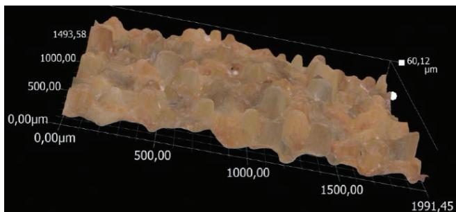
Foto ottenuta con microscopio ottico digitale e ricostruzione 3D della morfologia GLR.
